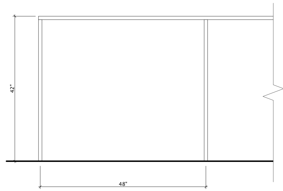
D1 SITE RAILING ELEVATION SCALE: 3/4" = 1'-0"
